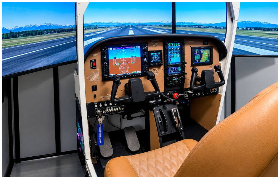
Simulador de Cessna 172, desarrollado íntegramente sobre una plataforma Glass Cockpit, que integra tecnologías de vanguardia como G1000, GN750, GN650, G5 y Autopilot, proporcionando una experiencia de vuelo inmersiva, precisa y funcionalmente fiel a la aeronave real.
